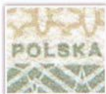
Mikrotekst pozytywowy w technice offsetowej
