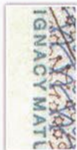
Mikrotekst pozytywowy w technice offsetowej
