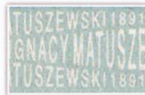
Mikrotekst negatywowy o zmiennej modulacji wysokości czcionki w technice offsetowej
