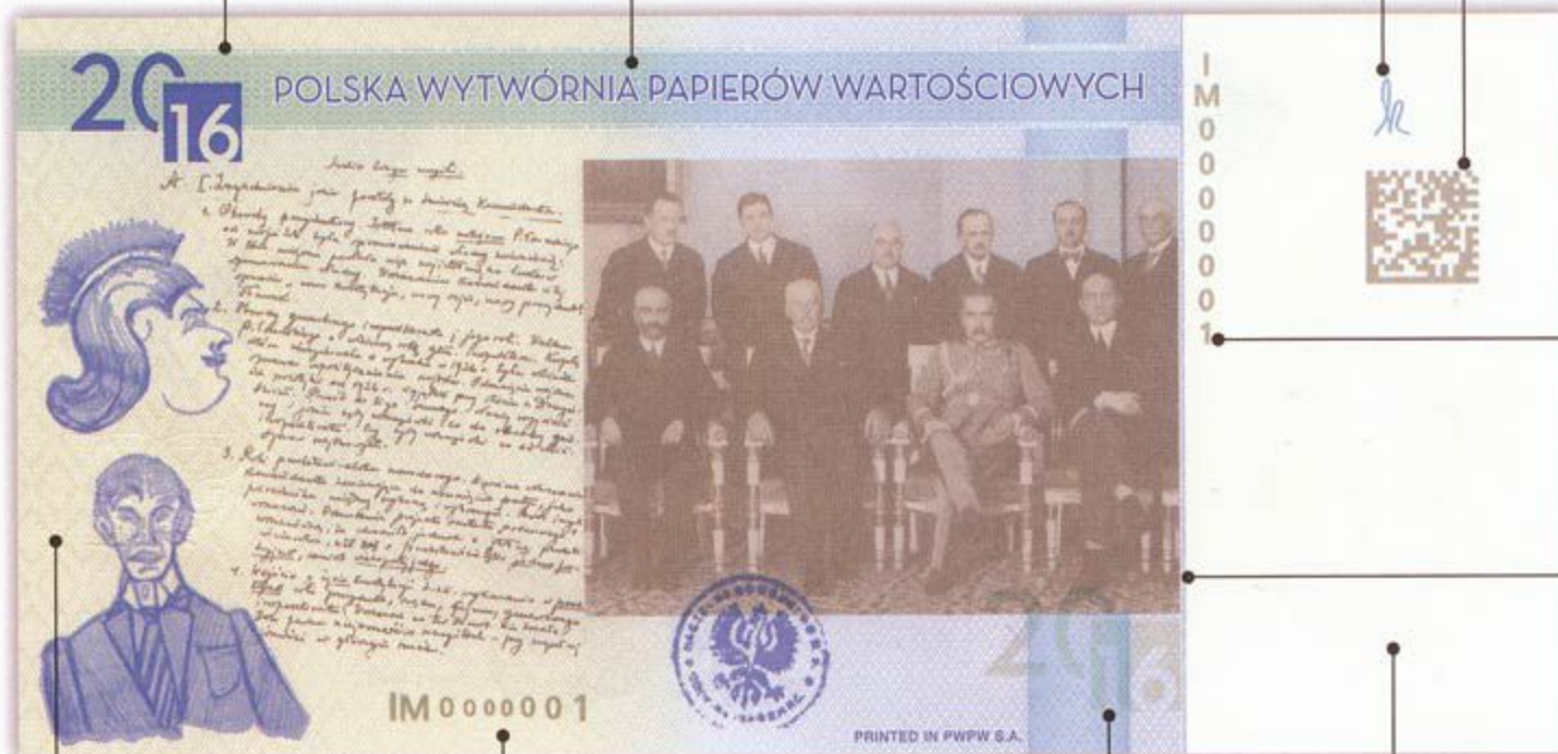
Numeracja wykonana techniką grawerowania laserowego
