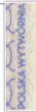
Mikrotekst pozytywowy w technice offsetowej
